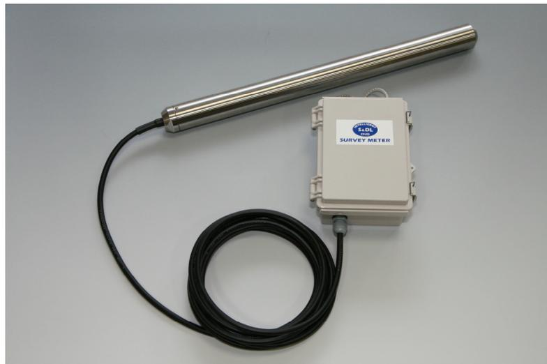
当社の開発した土壌・水中放射線量測定器 S&DL サーベイメーター
